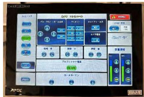
入力ソース[ カメラ ]を選択すると、カメラコントローラまたはタッチパネル画面からカメラの操作が行えます。タッチパネル画面から操作を行うと動きが重くなるので**カメラコントローラの使用を推奨します。**
