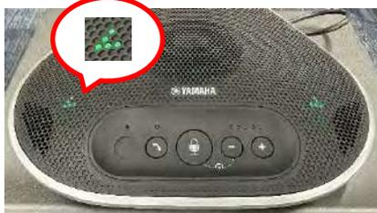
SoundCap 機能を有効にすると、周囲の騒音・雑音は自動的にミュートされ、集音範囲(半径 1m)の音声を拾います。また、周囲の雑音に合わせて自動でスピーカー放音量の調整が行われます。
